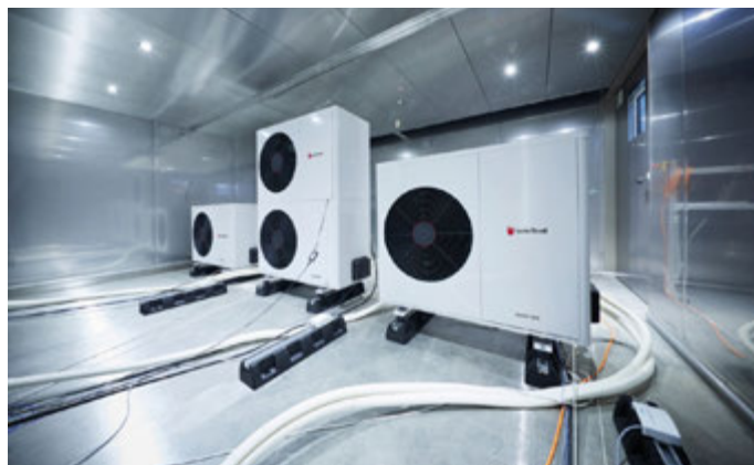
Komory klimatyczne symulują wszystkie potencjalne warunki eksploatacji
