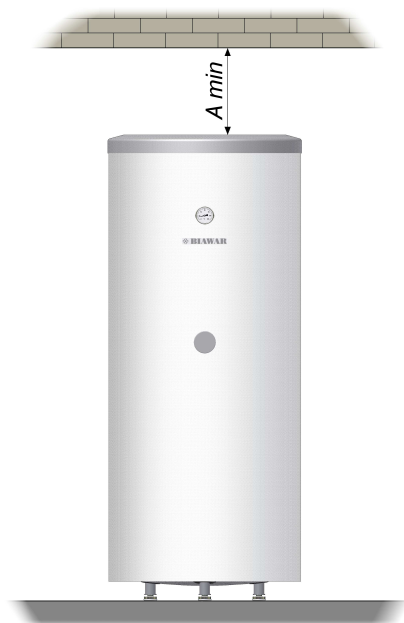
Rys. 5 Minimalna odległość do wymiany ochronnej anody magnezowej
