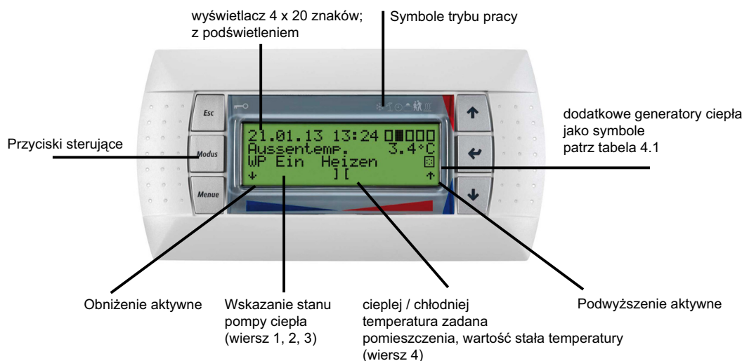
Rys. 4.1: Sterownik pompy ciepła z oddzielnym standardowym wyświetlaczem LCD z przyciskami do obsługi
