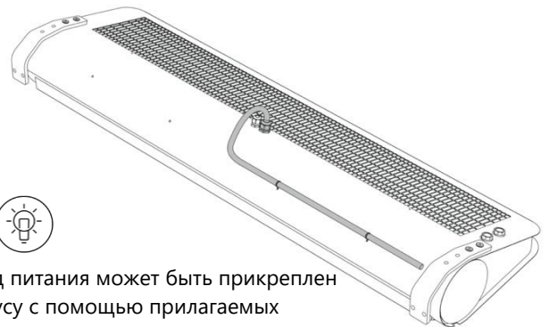
РИС. 11.6 ПРОКЛАДКА КАБЕЛЯ ВОКРУГ КОРПУСА
