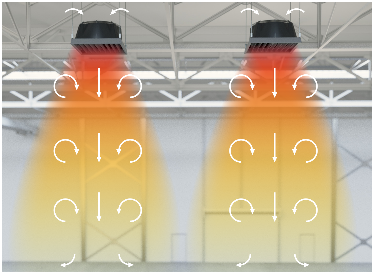
Przepływ powietrza z destratyfikatorem LEO D.
