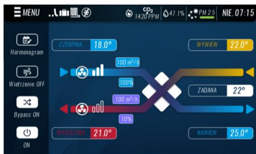
Widok ekranu głównego z załączonym bypasssem.
