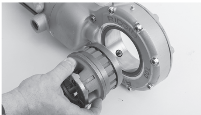
Figure 4 – Montage des têtes de filière sur le système d'entraînement électrique N° 700
