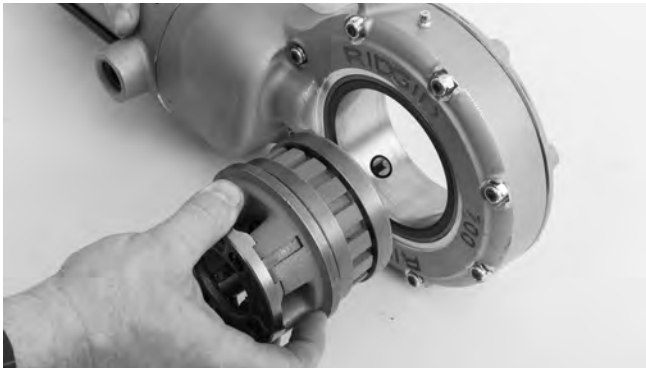
Abbildung 4 – Einsetzen der Schneidköpfe in den Kraftantrieb 700
