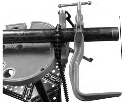
Abbildung 5 – Stützarm fluchtet mit Rohrende
