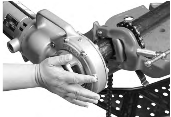
Abbildung 8 – Starten des Gewindeschneidvorgangs
