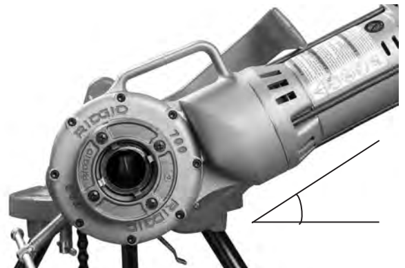
Abbildung 6 – Stützarm positioniert, Kraftantrieb 700 leicht über der Horizontalen
