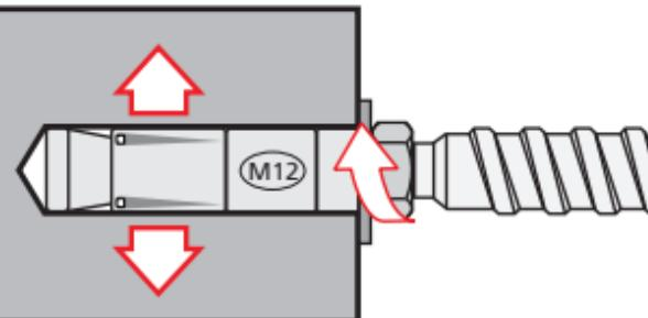
Beim Anziehen der Mutter wird der Konus in die Ankerschalen hineingezogen und spreizt diese auseinander und verkeilt sich
