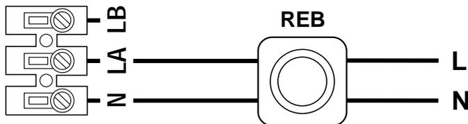
Funcionamiento a través de un regulador de velocidad variable Tipo REB
