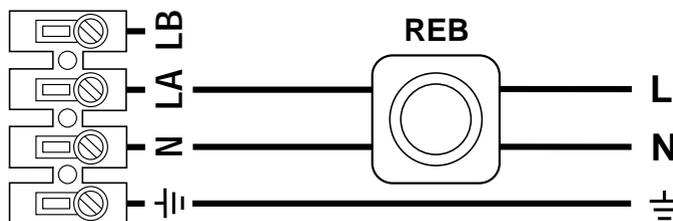
Funcionamiento a través de un regulador de velocidad variable Tipo REB
