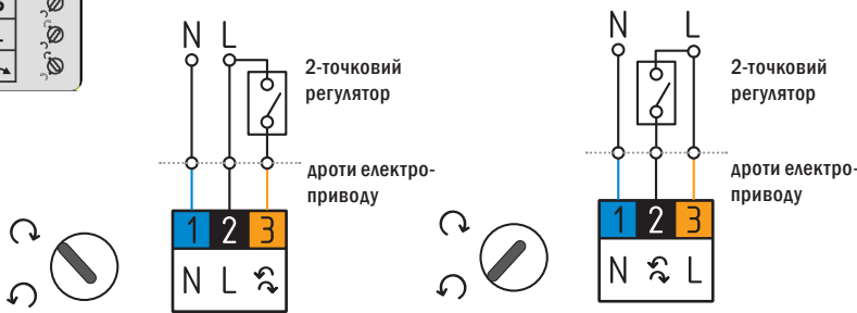
Рис. 7. Електрична схема 2-точкового привиду, налаштування у функції перемикачання
