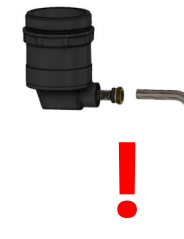
Рис. 12. Монтаж винта воздухоотводчика
