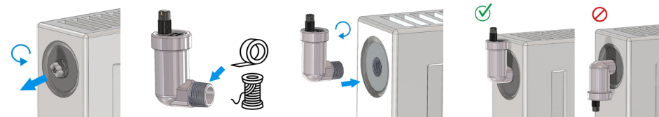
Рис. 2. Монтаж кутового повітровідвідника
