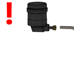
Рис. 12. Монтаж гвинта повітровідвідника
