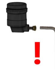
Рис. 12. Монтаж гвинта повітровідвідника
